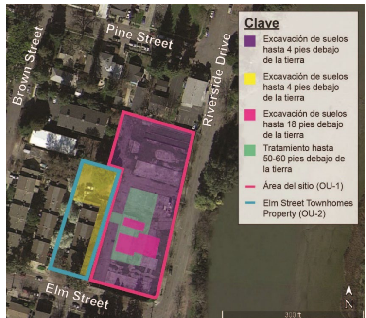
Figura del Sitio y las zonas en las que se llevó a cabo la descontaminación.
